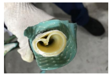
縦切開3重層高圧ホース経年劣化
