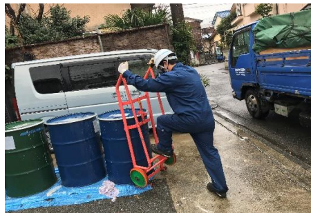
ドラムポーター差し込み
