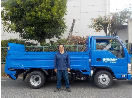
2トン車 (パワーゲート付平積みトラック (標準積載量:4m 3 ) 長さ:468cm 幅:169cm 高さ:196cm
