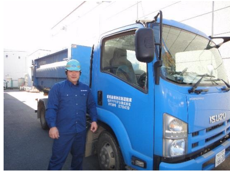
4トン車 コンテナアームロール車 (標準積載量:8m 3 ) 長さ:590cm 幅:220cm 高さ:246cm
