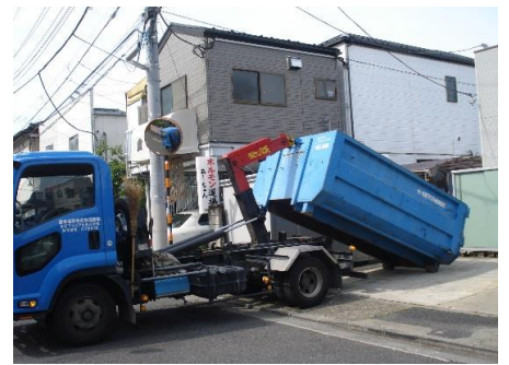
4トンコンテナを降ろす様子
