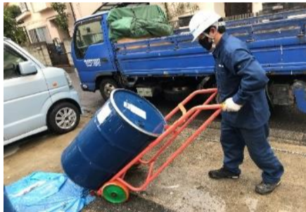
ドラムポーターで約200kgを運び出します
