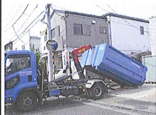
①4トンコンテナを降ろします
