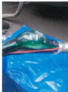
防食テープを剥すと ブレード入り耐圧ホースが内出血状態
