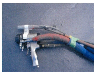
上部:スキッターマシンのノズル骨材噴射 下部:スプレーマシンガン
