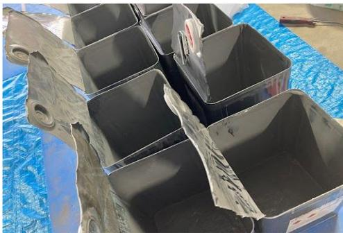
B: 5回使用后、底に材料の付着ある配り缶
