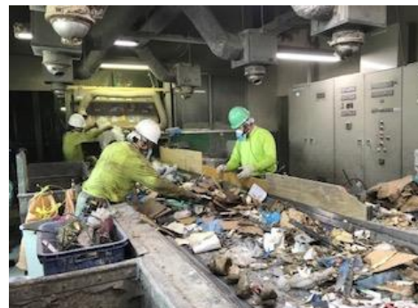
手選別コンベアでの作業
